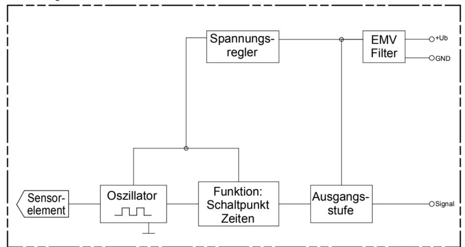
**Funktionsdiagramm für MINIMUM Sonden**
