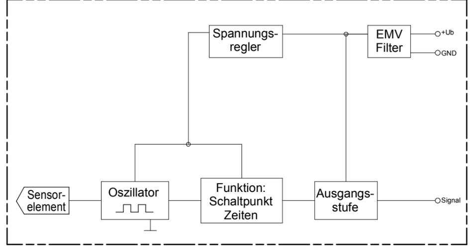
**Funktionsdiagramm für MINIMUM Sonden**
