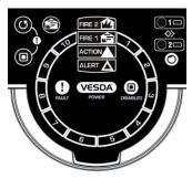
Wenn die Wartungstür geöffnet ist, kann der Benutzer auf folgende Funktionen zugreifen: ZURÜCKSETZEN (\*), AUSSCHALTEN (\*), Feuertest (\*), AutoLearn (\*) und sofortige Fehlersuche. Ist die Funktion "Sofortige Fehlersuche" aktiviert, dann schaltet sich die Rauchskala auf Fehleranzeige um, wobei die Skalasegmentnummern die unten angegebenen Fehler wiedergeben.
