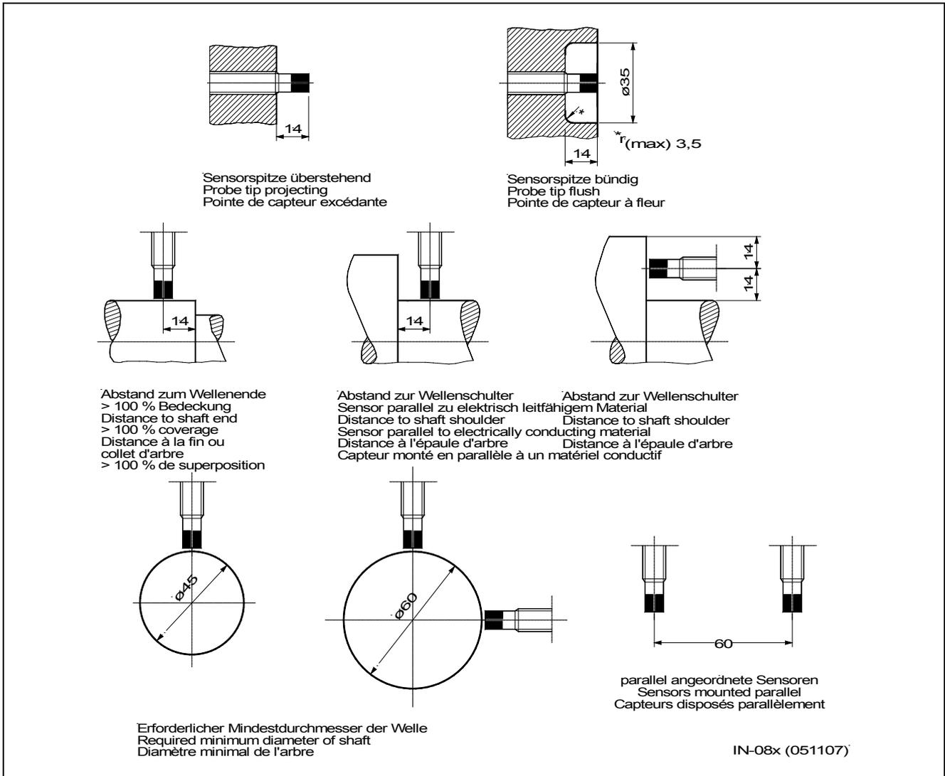
**Müssen die Freiräume und Mindestabstände konstruktionsbedingt unterschritten werden, ist eine Rücksprache beim Hersteller erforderlich.**
