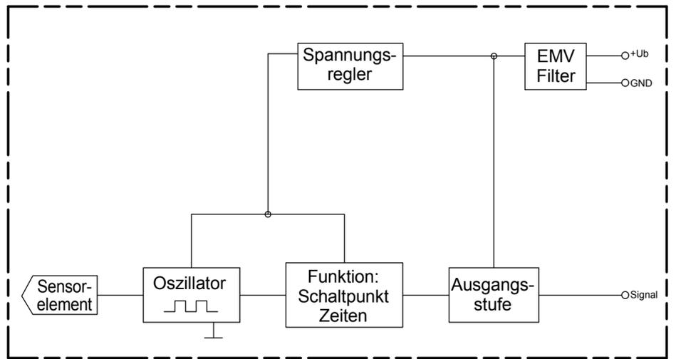
**Funktionsdiagramm für MINIMUM Sonden**
