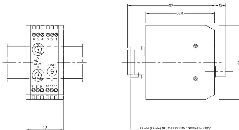
Sezione cavi collegamento (Cables size): 0,2-2,5 mm<sup>2</sup>
