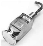
**Serie 117P - Druckschalter** für den unteren und mittleren Druckbereich, Schalterpunkt kundenseitig einstellbar stufenweise von 70 mbar fallend bis 50 bar steigend, Prozessanschluss in Tri-Clamp®\* benetzte Teile oberflächenpoliert (0,23 - 0,28 micron Ra).
