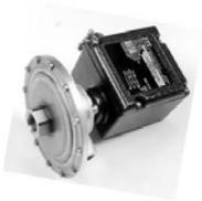
**Serie 142P8 - Druckschalter** für den niedrigen Unterdruckbereich von 0,62 mbar fallend stufenweise bis 99,6 mbar steigend einstellbar, auch mit ATEX EEx d und verschiedenen Materialien für die mediumpennetzte Seite, Einsatz in Ex gefährdeten Bereichen und korrosiven Medien, grosse Über-/ Unterdrucksicherheit.
