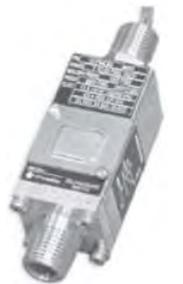
**Serie 181P - Druckschalter**, kundenseitig einstellbar im Niederdruckbereich von 67 mbar fallend bis 938 mbar steigend, geeignet für ein weites Anwendungsspektrum. Hysterese nach Kundenvorgabe bei der Produktion einstellbar.
