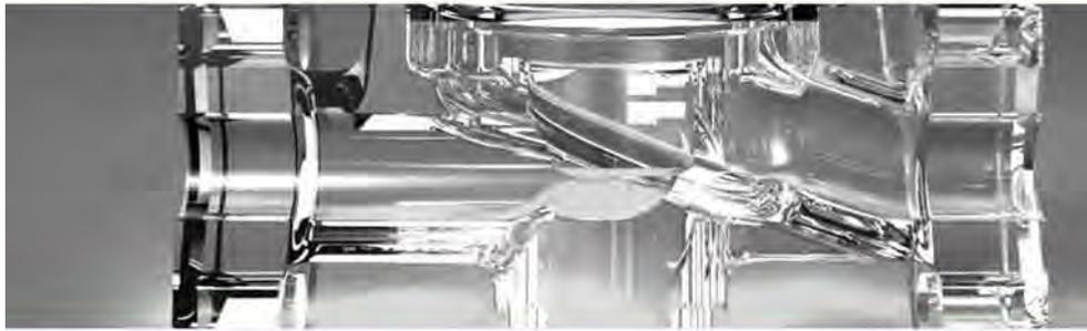
Zwangsgesteuerte Ventile schalten von 0 bar an und sind auch dort einsetzbar, wo direktgesteuerte Ventile ihren Einsatz finden. Sie werden jedoch über deren Einsatzbereich hinaus mit kleineren Magneten für höhere Drücke und größere Nennweiten geliefert. Bei zwangsgesteuerten Ventilen öffnet der Antrieb eine Vorsteuerbohrung und hebt dann direkt oder unterstützt von einer Differenz des Betriebsdruckes das Dichtelement vom Hauptsitz ab.
