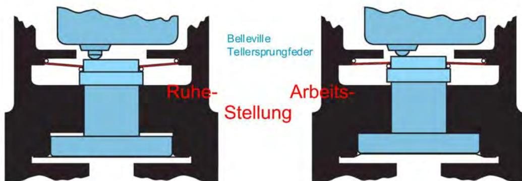
**Alle nachfolgend beschriebenen Geräte sind mit dem patentierten Belleville Tellerfeder System ausgerüstet und verfügen über die Eigenschaften kein Driften des Schaltpunktes, Vibrationsfest, Stabiler Schaltpunkt, Grosse Überdrucksicherheit.**
