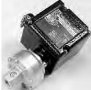
**Serie 100T - Temperaturschalter** für Direktanbau, kundenseitig einstellbarer Schalterpunkt stufenweise von -56°C fallend bis + 260°C steigend, schnelles Ansprechen für Messungen im Satteldampf, Ex-Gerät ATEX zertifiziert. Mit Schutzhülsen lieferbar.
