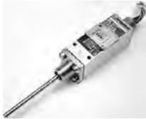
**Serie 132T - Temperaturschalter** für Direktanbau, kundenseitig einstellbarer Schalterpunkt stufenweise von -56°C fallend bis + 202°C steigend, schnelles Ansprechen für Messungen im Satteldampf, Ex-Gerät ATEX zertifiziert. Mit Schutzhülsen lieferbar.
