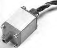
**Serie 130P - Druckschalter** für den mittleren Druckbereich von 0,1 bar fallend bis 11,7 bar steigend, Schaltpunkt wird bei der Herstellung fest eingestellt, damit ist der Druckschalter manipulationssicher. Kompakte Bauweise.
