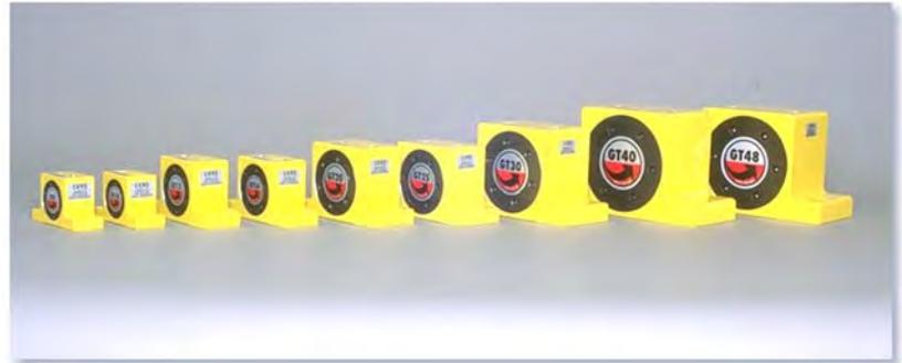
Die Vibration wird durch die Fliehkraft der positiv und negativ unbalancierten Momente im Rotor erzeugt. Die Lagerung des Rotors erfolgt mit zwei gekapselten mit Spezialfett versehenen Kugellagern welche eine hohe Lebensdauer garantieren. Eine Schmierung über die Druckluft ist daher nicht erforderlich.
