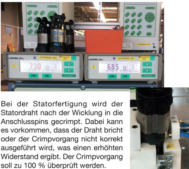
Bei der Statorfertigung wird der Stator Draht nach der Wicklung in die Anschlusspins gecrimpt. Dabei kann es vorkommen, dass der Draht bricht oder der Crimpvorgang nicht korrekt ausgeführt wird, was einen erhöhten Widerstand ergibt. Der Crimpvorgang soll zu 100 % überprüft werden.
