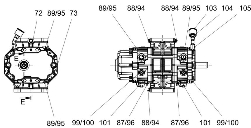
Alle innenliegenden Schrauben und Muttern gesichert mit Loctite 243.
