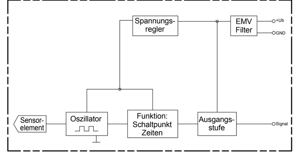
**Funktionsdiagramm für MAXIMUM Sonden**
