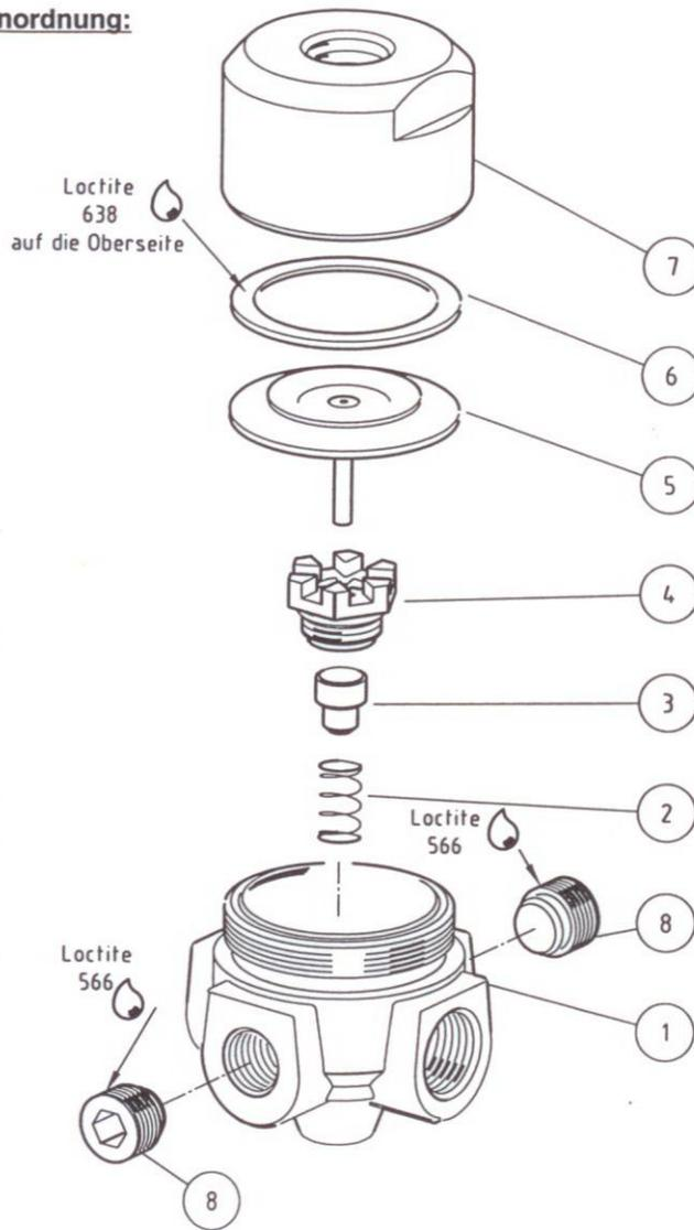
Die Montage von Membranring und Haube muß **vor dem Trocknen** des Klebers geschehen (binnen 2 Minuten). D.h. die Membranringe dürfen nicht vor dem Montieren in die Hauben eingeklebt werden, denn der Ring muß beim Einschrauben noch gleiten können, damit sich die Membran nicht verziehen kann.
