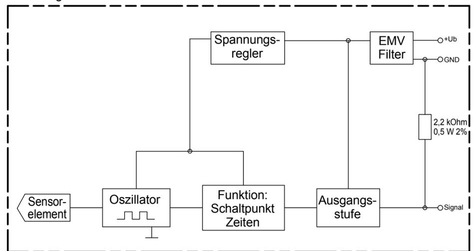
**Ⓐ Funktionsdiagramm für MINIMUM Sonden**
