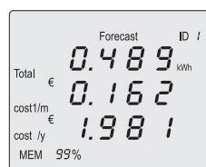
Zum Umschalten der Messwertanzeigen drücken Sie die Taste „MODE“ (5) für die nächste oder die „Weiter“-Pfeiltaste (7) für die vorhergende Anzeige. Jedes Drücken schaltet die Anzeige um.
