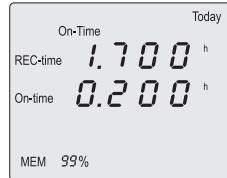
Über die beiden Pfeiltasten (3 und 4) können die Tage zurück und vorgeschaltet werden. Dies wird unter der Display-Einblendung „Today“ z.B. als „1“ bis „-9“ dargestellt. Nach der Anzeige „-9“ wird die gesamte Zeit (Total) dargestellt.
