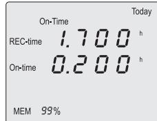
Met behulp van de beide pijltjes (3 en 4) kunnen de dagen terug en vooruit worden geschakeld. Dit wordt onder het displaysymbool „Today“ b.v als „1“ tot „-9“ weergegeven. Na de waarden voor „-9“ wordt de totale tijd (Total) weergegeven.
