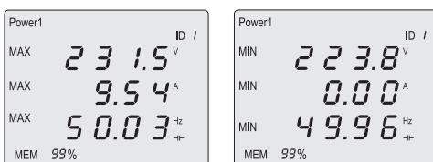
→ Um den MAX/MIN-Speicher zu löschen, halten Sie die beiden Tasten „min“ und „max“ gleichzeitig für ca. 2 Sekunden gedrückt. Die Daten sind gelöscht, wenn in der Anzeige „MAX/MIN“ gleichzeitig erscheint.
