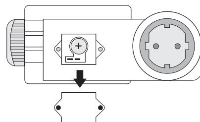
Gebruik het meetapparaat in geen geval in geopende toestand! LEVENSGEVAAR!
