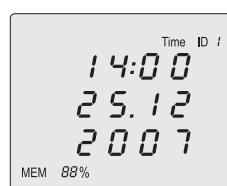
Zum Umschalten der Messwertanzeigen drücken Sie die Taste „MODE“ (5) für die nächste oder die „Weiter“-Pfeiltaste (7) für die vorhergende Anzeige. Jedes Drücken schaltet die Anzeige um. Nach der letzten Anzeige beginnt diese wieder bei Anzeige „Power1“.
