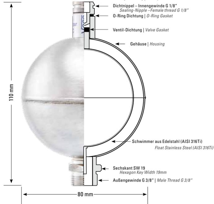
Wir empfehlen den PURG-INOX 2000 mit Kugelhahn-Absperrung aus Edelstahl zu montieren. Kugelhahn-Absperrung G 3/8"
