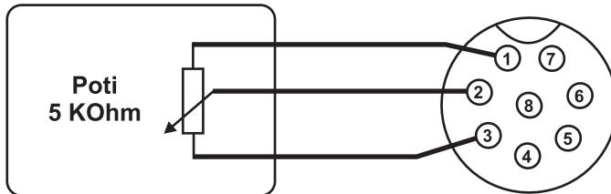
Schakel de schakelnetvoeding uit en verbind vervolgens de REMOTE-stekker met de Remote-aansluiting aan de achterkant. Schroef de buitenste bevestigingsring vast.
