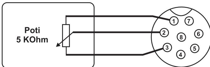
Mettre le réseau d'alimentation hors circuit, puis relier ensuite le connecteur REMOTE à la prise Remote située au dos. Visser la bague de fixation extérieure.
