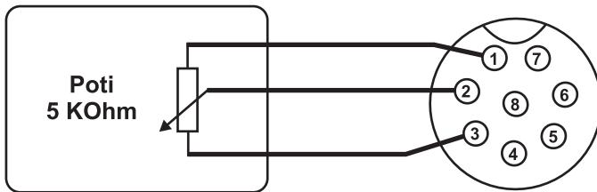
Schalten Sie das Schaltnetzteil aus und verbinden dann den REMOTE-Stecker mit dem rückseitigen Remote-Anschluss. Verschrauben Sie den äußeren Befestigungsring.
