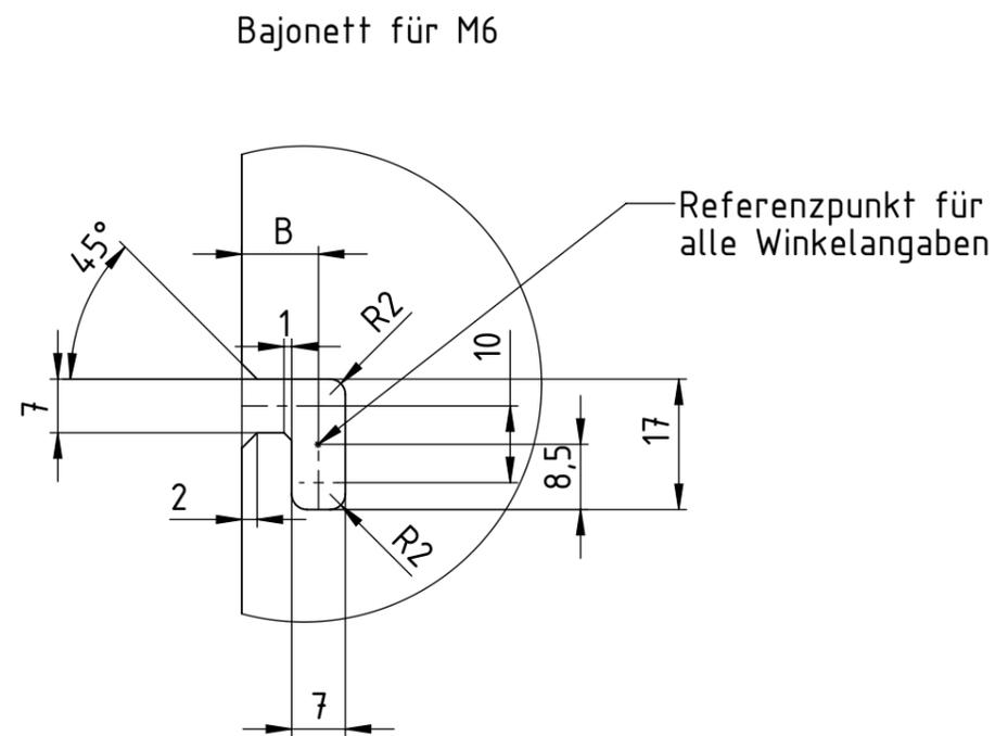
Beispielrohr (rechtsdrehende Verriegelung)
