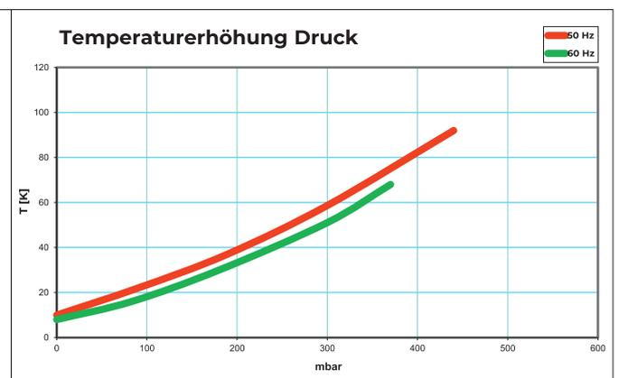
Die Kennlinien haben eine Toleranz von  $\pm 10\%$  und beziehen sich auf freie atmosphärische Luft von 1 bar (abs.) und 20°C.
