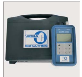
Service messgerät SWM 4000 mit Servicekoffer
