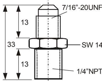
**Adapter 1/4" NPT-Außengewinde -7/16"-20UNF-**
