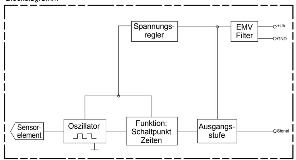
**Funktionsdiagramm für MINIMUM Sonden**
