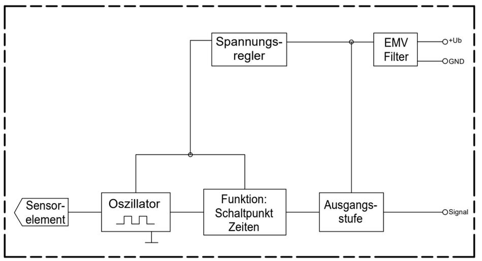
**Funktionsdiagramm für MAXIMUM Sonden**
