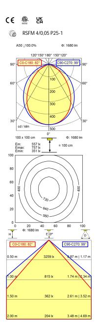
LED Bestückung Betriebsgerät Ohne Anschlusswerte 20 - 28 V; DC ca. 16 W Leistungsaufnahme Lichtstrom ca. 1.680 lm Leuchtenlichtausbeute 1) ca. 105 lm/W Lichtart/-farbe Neutralweiß **Farbtemperatur** ca. 5.000 K **Farbwiedergabe** Ra ≥ 80
