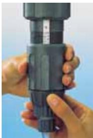
Die Einstellung der Dosierung wird durch das Drehen der Regulierschraube vorgenommen, deren oberer Rand mit dem gewünschten Wert auf der Dosierskala übereinstimmen muss. Die eingespritzte Konzentratsmenge ist proportional zum Wasservolumen, das den Dosatron durchfließt : z.B. : Einstellung auf 1% = 1 : 100 = 1 Volumen des Konzentrats plus 100 Volumen Wasser
