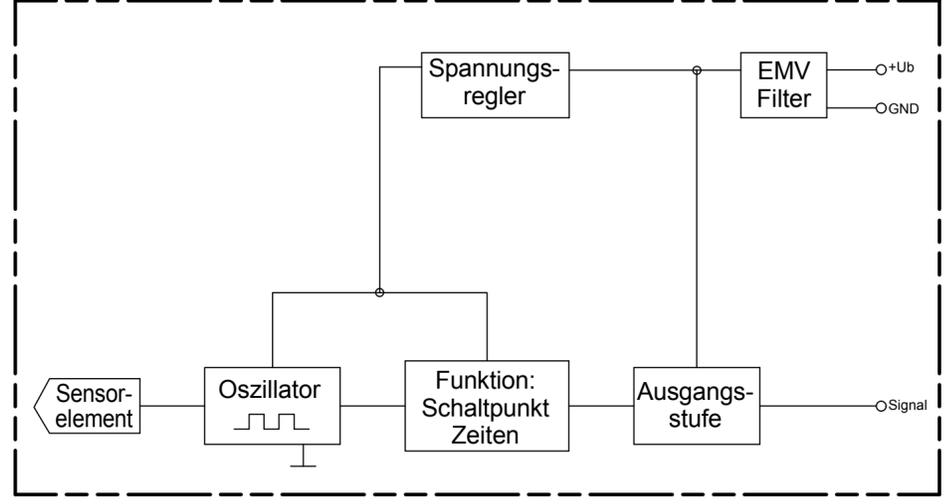
**Funktionsdiagramm für MINIMUM Sonden (b)**
