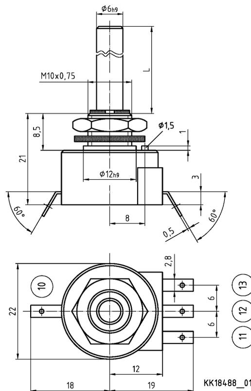
Zugkraft an den Flachsteckern (60 N) prüfen
